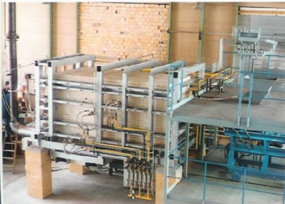
Technikum mit 5-t/d-Schnellschmelzreaktor
